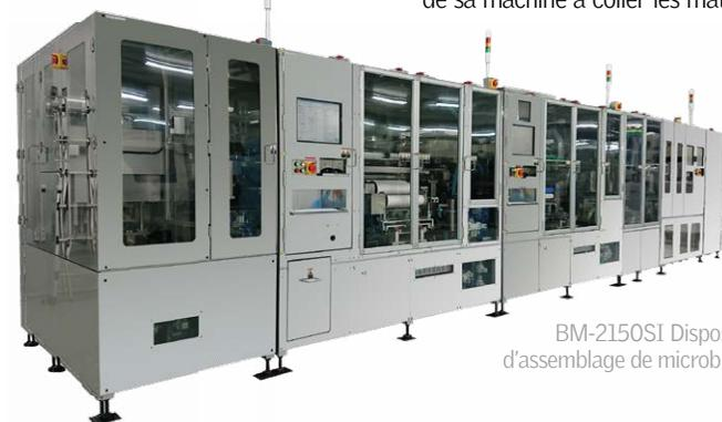
BM-2150SI Dispositif d'assemblage de microbilles
